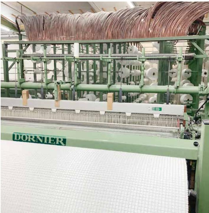
Das Trägermaterial mit deutlich erkennbarer Gitterstruktur wird auf dem Webstuhl gefertigt.
