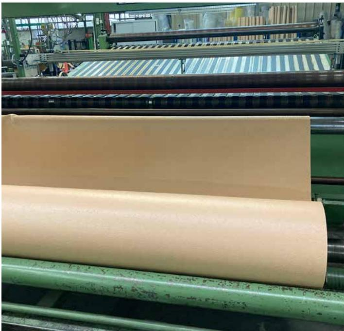
Auf Großkauten wird die Bahnenware für die Konfektionierung produziert.
